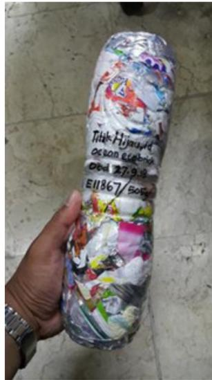
*Ocean Ecobrick* atau ecobrick laut adalah kelas ecobrick yang dirancang untuk plastik yang ditemukan di pantai, sungai, dan laut. Plastik ini cenderung besar, tebal, kotor, dan basah dan tidak cocok untuk membuat ecobrick biasa. Teknik *ocean ecobrick* memungkinkan plastik ini dengan mudah diubah menjadi blok bangunan yang praktis, berguna, dan dapat digunakan kembali.
